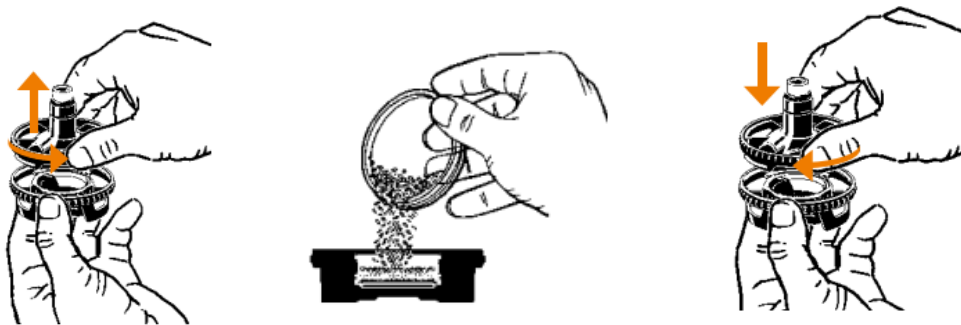
ΑΦΑΙΡΕΣΗ ΤΟΥ ΚΑΠΑΚΙΟΥ ΑΠΟ ΤΟΝ ΘΑΛΑΜΟ ΠΛΗΡΩΣΗΣ, ΠΛΗΡΩΣΗ ΤΟΥ ΘΑΛΑΜΟΥ ΠΛΗΡΩΣΗΣ ΜΕ ΤΗΝ ΑΠΑΙΤΟΥΜΕΝΗ ΔΟΣΗ ΚΑΙ ΕΠΑΝΑΝΑΤΟΠΟΘΕΤΗΣΗ ΤΟΥ ΚΑΠΑΚΙΟΥ
